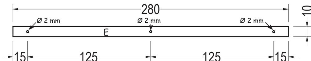
Perce 3 trous  $\varnothing 2$  mm dans la latte (E) selon le schéma.
