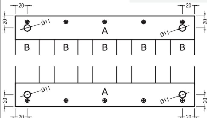
Bohre die Löcher  $\varnothing 11$  mm.
