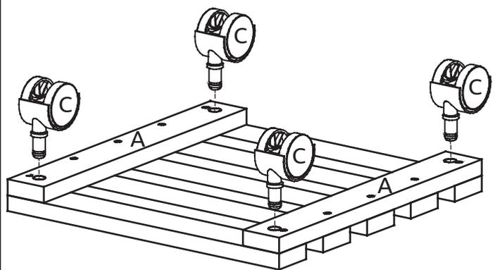
Stecke die Räder (C) in die Bohrungen  $\varnothing 11$  mm.
